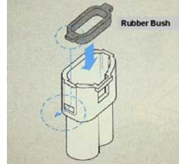
制品的橡胶衬垫插入状态的检查
