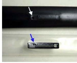
▶ 灌溉用水管的散水孔位置的检查
